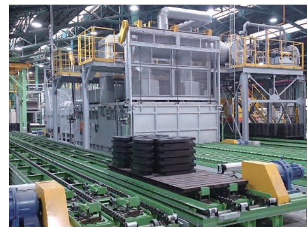
耐火物製造自動化プラント
