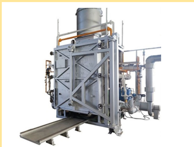
省エネルギー型熱処理・工業炉 (プロトタイプ、有効容積1.3m 3 )
