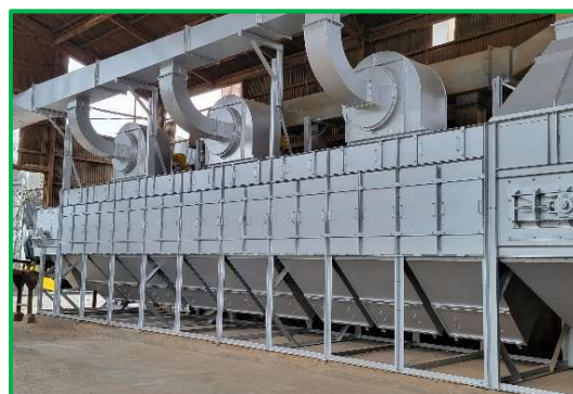
排熱活用の乾燥炉(ものづくり補助金取得設備)
