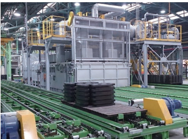
耐火物製造自動化プラント
